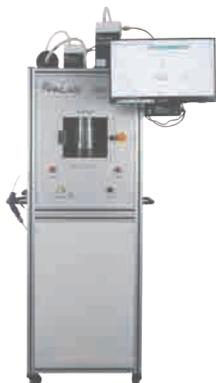
PMFT 1000 F，全能型号，可胜任几乎所有类型口罩和滤料的检测。总渗透测试优于标准，精确分析 145 nm 至 40  $\mu\text{m}$  的口罩过滤效率
